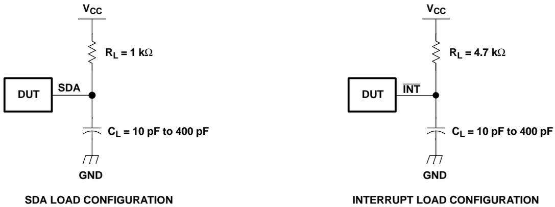
**Figure 4. Load Circuits**
